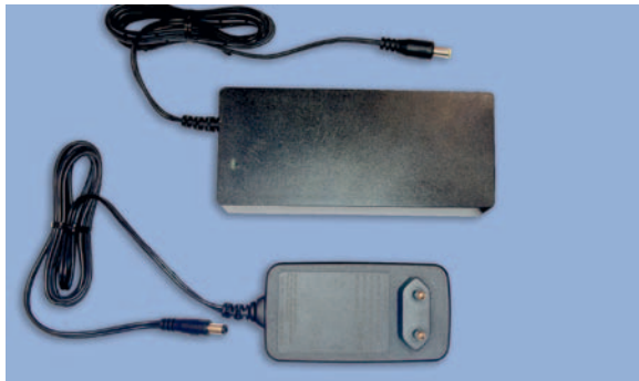
Bild 3: Ein 60-W-Chibi-LLC-Konverter für die Wandmontage und ein normaler 60-W-Flyback-Konverter für den Desktop-Bereich (Flyback oben, Chibi-LCC unten).
